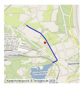
Über die Malxe erfolgt die Leitung des gefilterten Grubenwassers vom Absetzbecken zum Hinleiter des Kraftwerks, um benötigtes Brauchwasser bereitzustellen.
