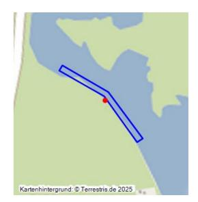
In diesem Bereich wurde in den 1990er Jahren durch die LMBV eine leichte Rütteldruckverdichtung im Flachwasser- und Uferbereich zur Herstellung der Standsicherheit durchgeführt.
