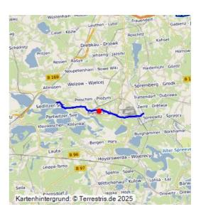
Der Obere Landgraben führt von der Pumpstation Spreewitz (Sachsen) an der Spree über eine Länge von 21,4 km bis zum Einlaufbauwerk in den Sedlitzer See. Von der Pumpstation bis zur Unterquerung der B 156 zwischen Terpe und Sabrodt wird das Wasser in einer Rohrleitung geführt, danach in einem offenen Graben.
