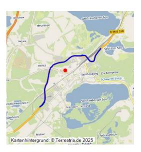
Der Streckenabschnitt der B 169 nordwestlich von Senftenberg wurde von 2003 bis 2008 als Ortsumfahrung erbaut. Ca. 87 Prozent der etwa 13 km langen Strecke verlaufen über verdichtetes Kippengelände, u.a. über den Südrandschlauch des Tagebaus Meuro. Aufgrund von Hohlräumen, die eventuell auf alte Entwässerungskanäle des Bergbaus zurückgehen, wurde von 2021 bis 2022 ein ca. 400 m langer Straßenabschnitt zwischen Senftenberg und Sedlitz verfüllt, stabilisiert und saniert.
