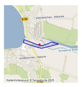
Der Koschener Kanal ist eine künstlich angelegte, schiffbare Verbindung zwischen dem Geierswalder See und dem Senftenberger See. Neben der touristischen Nutzbarkeit sorgt der Kanal mit einem maximalen Durchfluss von 5 m³/s auch für einen Ausgleich des Wasserhaushalts zwischen beiden Seen. Der Geierswalder See entwässert durch den Koschener Kanal in den Senftenberger See und von dort weiter in die Schwarze Elster.
