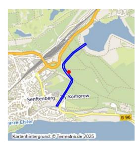
Über den Ableiter am Sedlitzer See wird zukünftig der Wasserhaushalt der Restlochkette Sedlitz-Skado-Koschen reguliert. Er dient als Anschluss der gefluteten Bergbaufolgeseen an die Vorflut Schwarze Elster.
