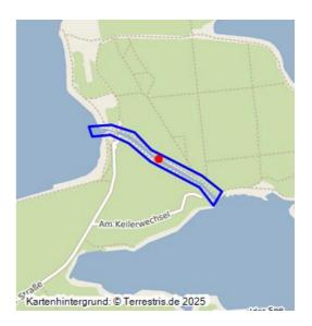
Der Sornoer Kanal ist eine künstlich angelegte, schiffbare Verbindung zwischen dem Geierswalder See und dem Sedlitzer See. Neben der touristischen Nutzbarkeit sorgt der Kanal mit einem maximalen Durchfluss von 5 m³/s auch für einen Ausgleich des Wasserhaushalts zwischen beiden Seen. Der Geierswalder See und vorgelagerte Seen der Restlochkette entwässern durch den Sornoer Kanal in den Sedlitzer See und von dort weiter in die Vorflut (Rainitza und Schwarze Elster).
