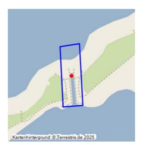
Der Rosendorfer Kanal ist eine künstlich angelegte, schiffbare Verbindung zwischen dem Partwitzer See und dem Sedlitzer See. Neben der touristischen Nutzbarkeit sorgt der Kanal mit einem maximalen Durchfluss von 5 m³/s auch für einen Ausgleich des Wasserhaushalts zwischen beiden Seen. Der Partwitzer See und vorgelagerte Seen der Restlochkette entwässern durch den Rosendorfer Kanal in den Sedlitzer See und von dort weiter in die Vorflut (Rainitza und Schwarze Elster).
