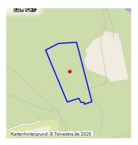
Im Tiefbau Wildgrube bauten die Beutersitzer Kohlenwerke noch zwischen 1926 und 1938 im Pfeilerbruchbauverfahren Braunkohle ab. Die Bruchfelder wurden von späteren Tagebauen zum Verkippen von Abraum verwendet.
