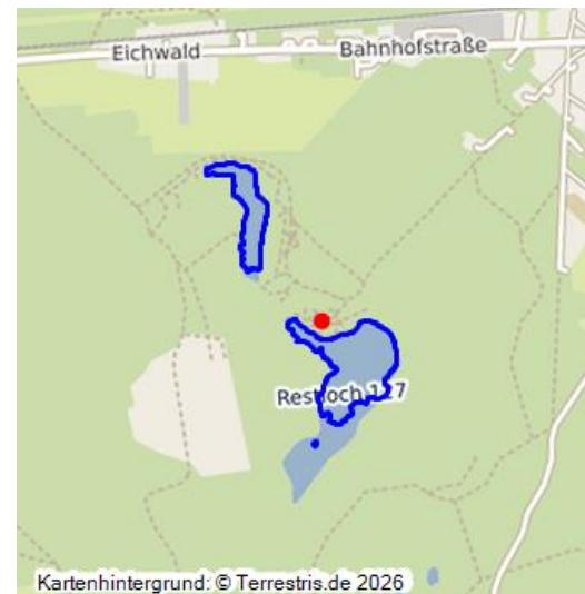
Die beiden Teilbereiche des Restlochs 127 entstanden durch natürlichen Wasserzufluss und Grundwasseranstieg in aufgelassenen Bereichen des Tagebaus Tröbitz-Südfeld (1947-1957) sowie im nord-östlichen Bereich des Tagebaus Wildgrube (1925-1952).
