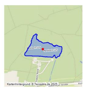
Das Restloch 125 entstand durch zulaufendes Grundwasser im aufgelassenen Bereich des Tagebaus Tröbitz-Westfeld. Im südlichen Bereich erstreckt sich die sehr steile Böschung über zwei Terrassen. Am nördlichen Ufer ist sie eher eher flach auslaufend.
