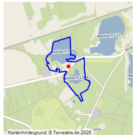
Der Tagebau der Beutersitzer Kohlewerke wurde nach dem Beschluss zum Bau der Briketfabrik 1898 aufgeschlossen. Der Abraum wurde manuell abgetragen und mit Kipploren im Bruchfeld des Tiefbaus Louise (östlich und südöstlich) verkippt. Über eine giegsgebundene Seilbahn wurde die Kohle in die Briketfabrik Wilhelm Wildgrube transportiert.
