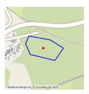
Ab 05.02.1867 abgebautes Tagebaufeld. Die Deckschicht bestand hier nur aus 0,5-1,5 m Sand, darunter lag ein 6 m mächtiges Kohleflöz. Zunächst wurde lediglich bis zum Grundwasserspiegel abgebaut, später über einen Graben und einen Entwässerungsstollen der Grundwasserspiegel abgesenkt. Dadurch konnte bis 1868 etwa die Hälfte des Flözes abgebaut werden. Um Verwechselungen zu vermeiden, benannten die Eigentümer die Grube auf Bitte des Bergamtes in Emilie-Westfeld, bzw. Emilie II um.
