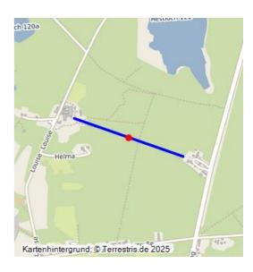
Über eine Seilbahnanlage wurde die Kohle aus dem Tiefbau der Grube Alwine zur Brikettfabrik Louise transportiert. Die Anlage wurde mit dem Bau der Bahnstrecke nach Beutersitz außer Betrieb genommen. Der Verlauf der Seilbahnstrecke entspricht dem Waldweg zwischen der Grube und der Brikettfabrik und ist somit im Gelände noch gut nachvollziehbar.
