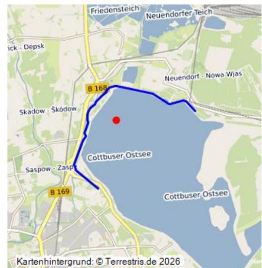
Die Dichtwand am Tagebau Cottbus-Nord wurde zum Schutz der FFH-Gebiete Peitzer Teiche, der Spreeaue und der Nordstadt Cottbus zwischen 1993 und 2007 angelegt. Sie erreicht bei einer Länge von 7.071 m Tiefen zwischen 51 und 72 m.
