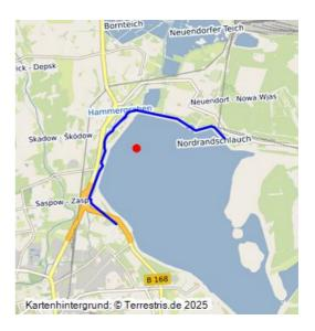
Die Dichtwand am Tagebau Cottbus-Nord wurde zum Schutz der FFH-Gebiete Peitzer Teiche, der Spreeaue und der Nordstadt Cottbus zwischen 1993 und 2007 angelegt. Sie erreicht bei einer Länge von 7.071 m Tiefen zwischen 51 und 72 m.
