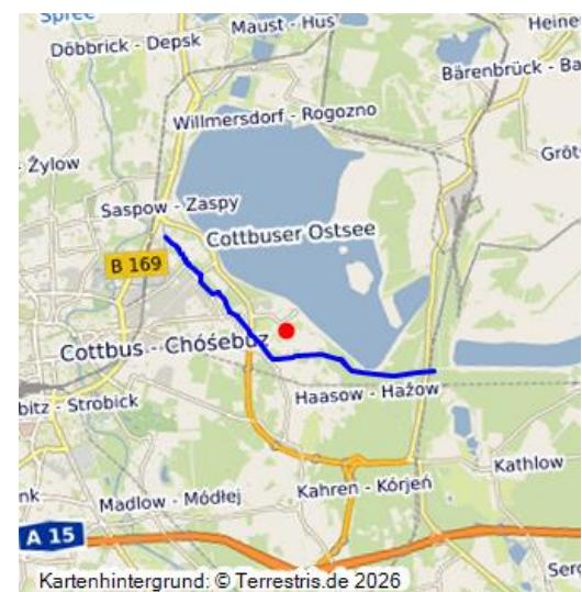
Der Bau des neuen Verlaufs der Tranitz vom Kathlower Wehr bis zum Hammergraben erfolgte ca. 1974/1975 im Auftrag des VEB Braunkohlekraftwerke im Zusammenhang mit der Erschließung des Tagebaus Cottbus-Nord. Die Tranitz diente auch als Ableiter für Grubenwasser aus den beiden Tagebauen Cottbus-Nord und Jänschwalde.
