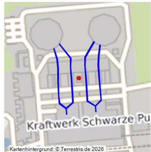
Über die Rauchgaskanäle werden Rauchgase aus den Dampferzeugern über die Rauchgasreinigung bis zur Ableitung in den Kühltürmen geleitet. Dabei wird die Wärme der Rauchgase genutzt, um in einem Wärmetauscher, dem Luftvorwärmer, die Verbrennerluft vorzuwärmen. Nach Durchlaufen der Rauchgasreinigung weisen die Rauchgase bei Einleitung in die Kühltürme eine Temperatur von etwa 65 Grad C auf.
