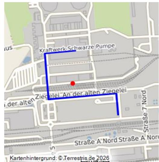
Die zweistraßige Förderbandanlage mit einer Gesamtlänge von je 1,3 km stellt die Verbindung zwischen dem Rohkohlebunker und den Tagesbunkern im Kraftwerk dar, über die Rohbraunkohle gefördert wird. Die Gesamtfördermenge beträgt je Straße 2.400 t/h. Während des Transports werden Produkte der Mitverbrennung zugesetzt.
