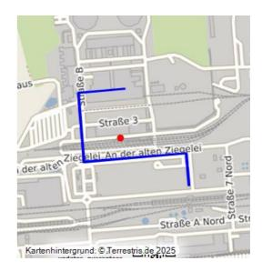
Die zweistraßige Förderbandanlage mit einer Gesamtlänge von je 1,3 km stellt die Verbindung zwischen dem Rohkohlebunker und den Tagesbunkern im Kraftwerk dar, über die Rohbraunkohle gefördert wird. Die Gesamtfördermenge beträgt je Straße 2.400 t/h. Während des Transports werden Produkte der Mitverbrennung zugesetzt.
