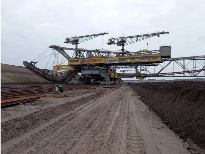
Eimerkettenbagger Es 3750 1307 Fotograf/Urheber: Marie Mamerow
