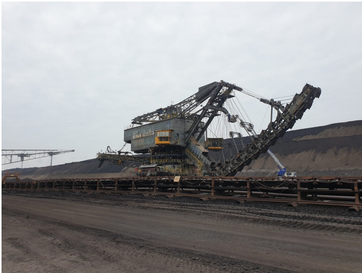
Eimerkettenbagger ERs 710 358 Fotograf/Urheber: Kirsten Krepelin
