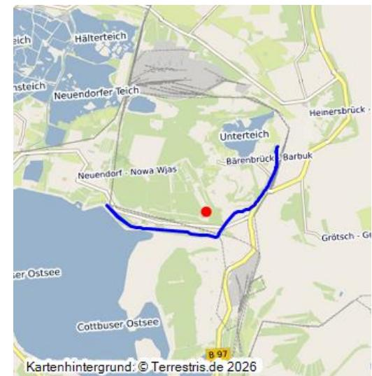
Über den Grubenwasserableiter 2 wird, ebenso wie über den Grubenwasserableiter 1, das im Tagebau Cottbus-Nord (Betriebszeit 1975-2015) gehobene Grundwasser in die Tranitz geleitet, von wo es über die Malxe zur Grubenwasserreinigungsanlage (GWRA) Kraftwerk Jänschwalde gelangt. Im Anschluß an den Reinigungsprozess in der GWRA wird das gereinigte Wasser in den Hammergraben und die Malxe geleitet, wo es zur Abflussstabilisierung der Spree beiträgt.
