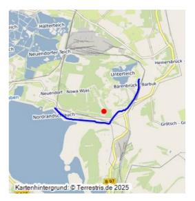
Über den Grubenwasserableiter 2 wird, ebenso wie über den Grubenwasserableiter 1, das im Tagebau Cottbus-Nord (Betriebszeit 1975-2015) gehobene Grundwasser in die Tranitz geleitet, von wo es über die Malxe zur Grubenwasserreinigungsanlage (GWRA) Kraftwerk Jänschwalde gelangt. Im Anschluß an den Reinigungsprozess in der GWRA wird das gereinigte Wasser in den Hammergraben und die Malxe geleitet, wo es zur Abflussstabilisierung der Spree beiträgt.
