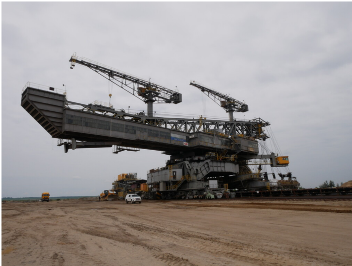
Eimerkettenbagger Es 3150 1285 Fotograf/Urheber: Louise Warnow
