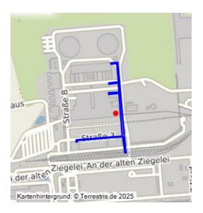
Über die Versorgungsanlagen (Förderbandanlagen und Rohrleitsysteme) wird Kalk in das Kraftwerk und entstandener Gips sowie anfallende Asche aus dem Kraftwerk gefördert. Sie stellen Verbindungen zwischen dem Kraftwerk und den Lagerplätzen dar. Dabei sind die Versorgungsanlagen auf eine Gerüstkonstruktion gestützt und zur Vermeidung von Lärm und Staub entsprechend der gesamtkonzeptionellen Gestaltung des Kraftwerks mit einer Aluminiumeinhausung verkleidet.
