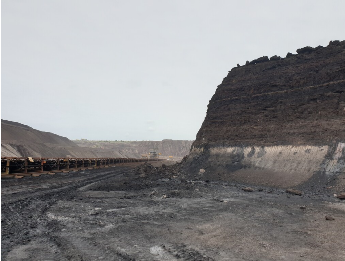
Gurtförderer vom Abbau zu Kohlebunker und Verladestation Fotograf/Urheber: Kirsten Krepellin
