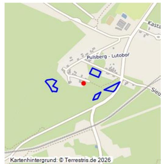
Das in einem Forstgebiet befindliche Tiefbaubruchfeld weist zahlreiche, im Grundriss kreisförmige bis ovale, oberirdisch abflusslose Senken auf. Die gute Ablesbarkeit sowie die hohe Anzahl und Dichte der sich im Gelände noch deutlich abzeichnenden Bodenmerkmale stellen einen nachvollziehbaren Bezug zum Braunkohlenbergbau her.
