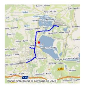
Die Grobverteilungsleitungen der Fernwärme (Heißdampf und Heißwasser) aus dem Heizkraftwerk Cottbus sowie dem Kraftwerk Jänschwalde wurde 1986 mit einer Länge von ca. 10 km in Betrieb genommen.
