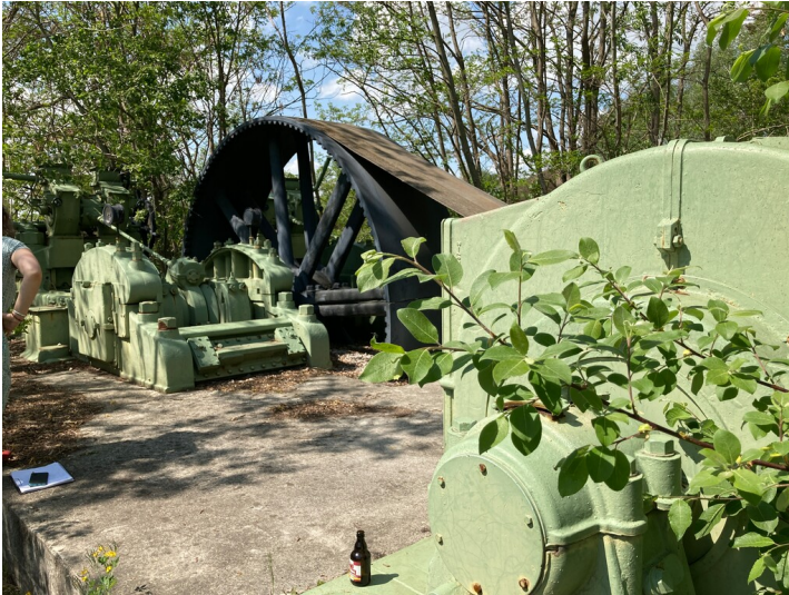
Ehemalige Doppelzwillingspresse mit Elektromotor aus einer Brikettfabrik in Espenhain, aufgestellt in der ehemaligen Neukirchen, Blick von Südosten. Fotograf/Urheber: Josephine Dressler
