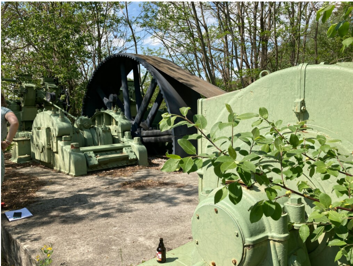
Ehemalige Doppelzwillingspresse mit Elektromotor aus einer Brikettfabrik in Espenhain, aufgestellt in der ehemaligen Neukirchen, Blick von Südosten. Fotograf/Urheber: Josephine Dressler
