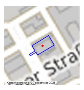
Im Zentrum der Fabrikanlage liegt zwischen dem Holzmehllager im Norden, der Formmassenproduktion im Osten, dem Sozial- und Verwaltungsgebäude im Süden sowie dem ehemaligen Lagergebäude für Phenole im Westen das Produktionsgebäude zur Herstellung von Phenolharzen. Diese dienen als Grundlage zur Erzeugung duroplastischer Formmassen.
