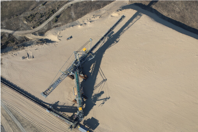
Teil der Objektgruppe Tagebau Reichwalde (30700270), Absetzer 1121 A2RsB 10000 zum Verstärken von Abraum des 1. Vorschnitts Fotograf/Urheber: Ronald Heynowski
