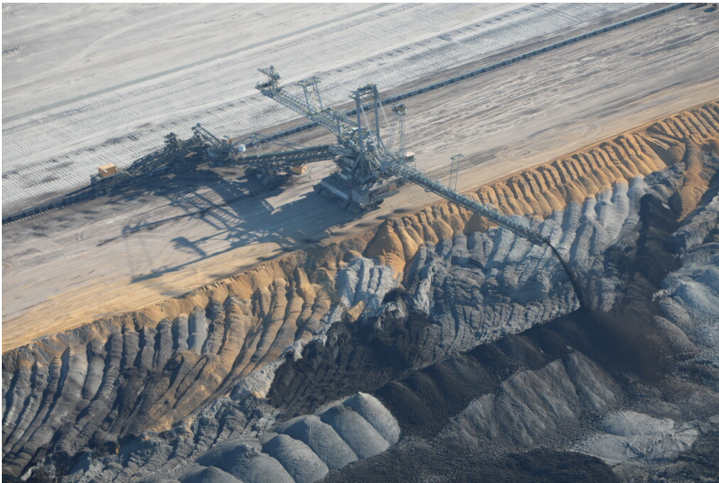
Teil der Objektgruppe Tagebau Nochten (31000343), Absetzer 1102 A2RsB 15400 zum Verstärken von Abraum des 1. Vorschnitts Fotograf/Urheber: Ronald Heynowski
