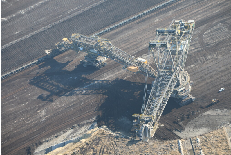
Teil der Objektgruppe Tagebau Nochten (31000343), Schaufelradbagger 1510 SRs 6300 zum Abtrag des 1. Vorschnittabbaus eingesetzt Fotograf/Urheber: Ronald Heynowski
