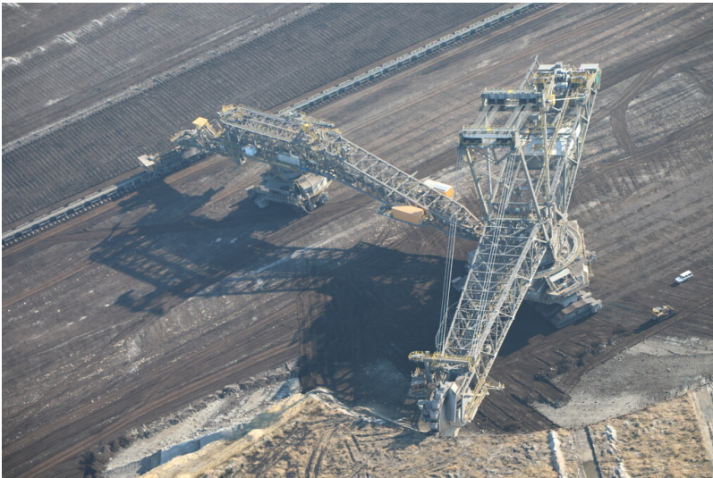
Teil der Objektgruppe Tagebau Nochten (31000343), Schaufelradbagger 1510 SRs 6300 zum Abtrag des 1. Vorschnittabraums eingesetzt Fotograf/Urheber: Ronald Heynowski
