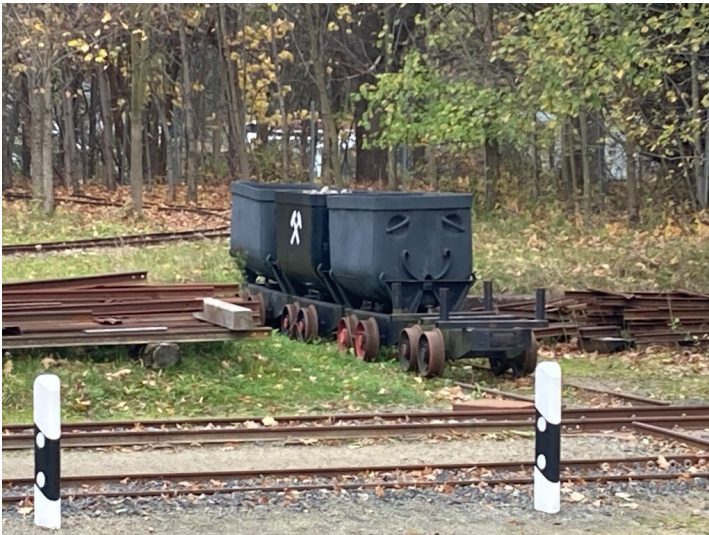
AG Grubenbahn, Kippförderwagen für 600 mm-Spur Fotograf/Urheber: Tom Pfefferkorn
