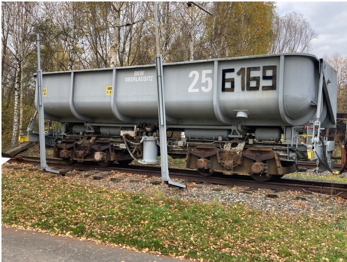
AG Grubenbahn, Abraumwagen für 900 mm-Spur, Seitenansicht Fotograf/Urheber: Tom Pfefferkorn
