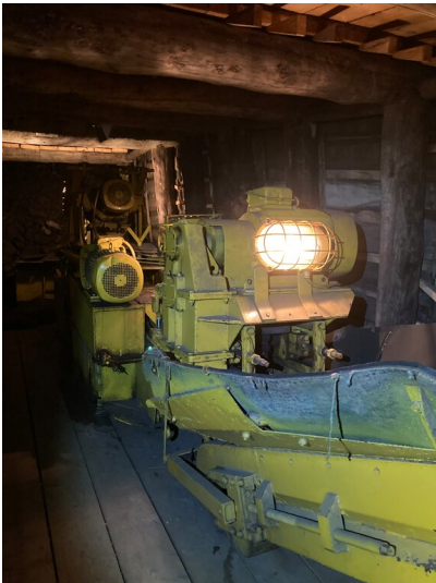
Bohrlafette mit Raupenfahrwerk, im Lausitzer Braunkohlebergbau zum Auffahren von Entwässerungsstrecken verwendet Fotograf/Urheber: Tom Pfefferkorn
