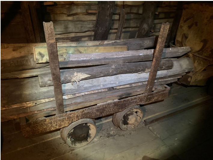
leichter Rungenwagen für Grubenholz Fotograf/Urheber: Tom Pfefferkorn
