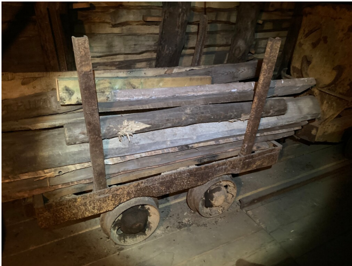
leichter Rungenwagen für Grubenholz Fotograf/Urheber: Tom Pfefferkorn
