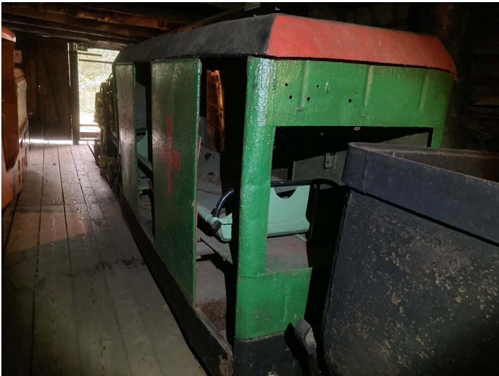
Rotkreuzwagen geschlossen, modifizierte Ausführung eines Untertagewagens zum Personentransport für 8 Personen Fotograf/Urheber: Tom Pfefferkorn
