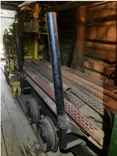
Rungenwagen zum Transport von Bohrgestängen etc. Fotograf/Urheber: Tom Pfefferkorn
