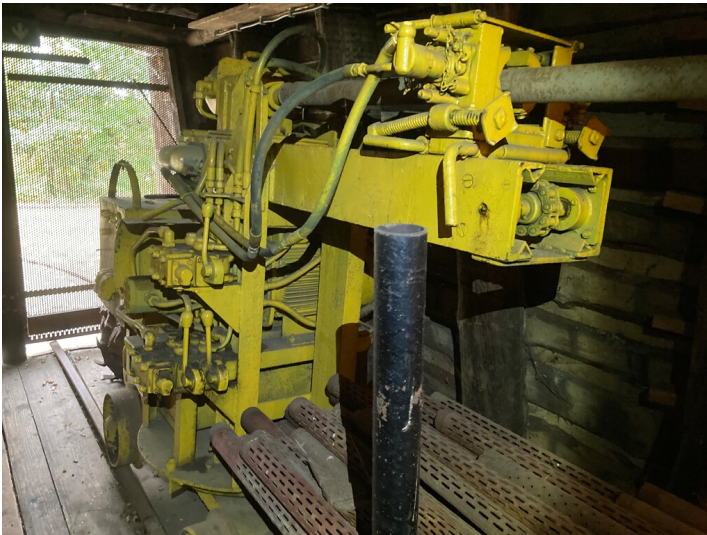
Bohrlafette, Basis zweiachsiges Fahrgestell mit vier Gussrädern, darauf längenverschiebbare und im Winkel veränderbare Bohrlafette Bohrlafette Fotograf/Urheber: Tom Pfefferkorn
