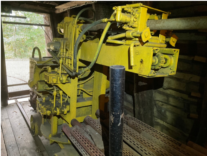
Bohrlafette, Basis zweiachsiges Fahrgestell mit vier Gussrädern, darauf längenverschiebbare und im Winkel veränderbare Bohrlafette Fotograf/Urheber: Tom Pfefferkorn
