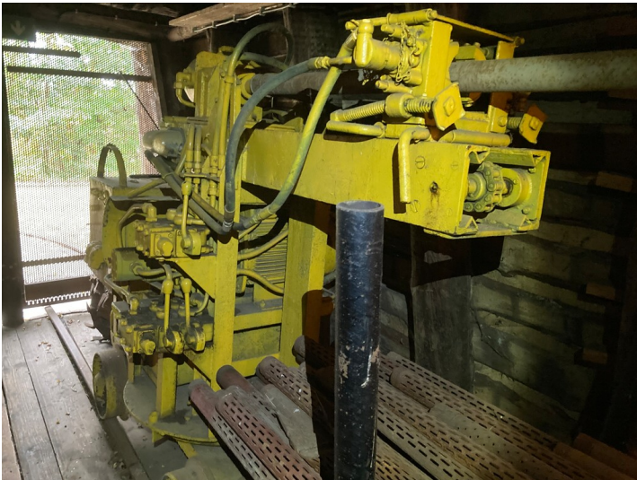
Bohrlafette, Basis zweiachsiges Fahrgestell mit vier Gussrädern, darauf längenverschiebbare und im Winkel veränderbare Bohrlafette Fotograf/Urheber: Tom Pfefferkorn
