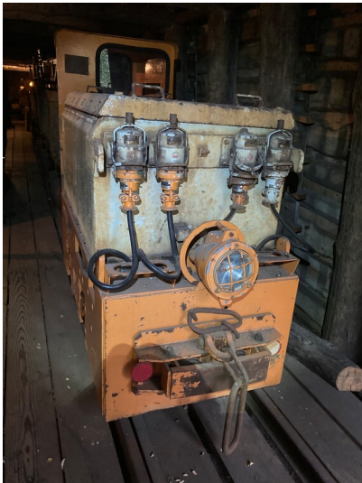
leichte Akku-Grubenlokomotive EL9 für den Untertageeinsatz, hier im Modell der Entwässerungsstrecke Fotograf/Urheber: Tom Pfefferkorn
