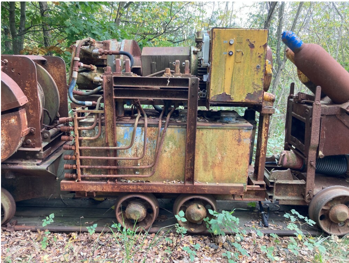
Spezialwagen, wohl für die Bereitstellung von Druckluft oder Hydrauliköl zum Betrieb von Bergbaugeräten Fotograf/Urheber: Tom Pfefferkorn
