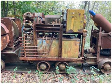
Spezialwagen, wohl für die Bereitstellung von Druckluft oder Hydrauliköl zum Betrieb von Bergbaugeräten Fotograf/Urheber: Tom Pfefferkom
