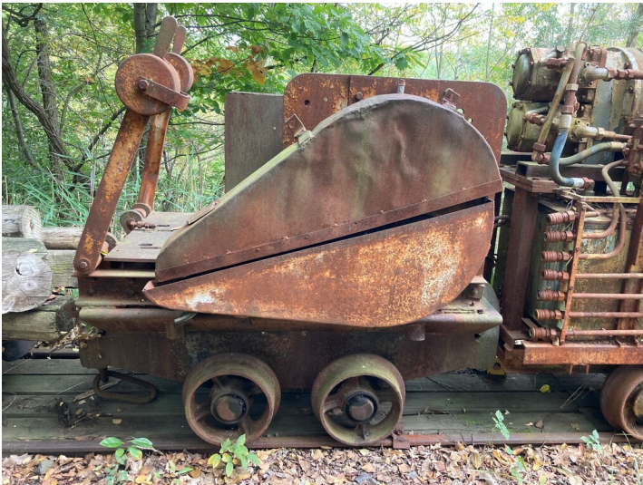
Flachwagen mit Seilwinde auf Basis eines Materialtransportwagens Fotograf/Urheber: Tom Pfefferkorn
