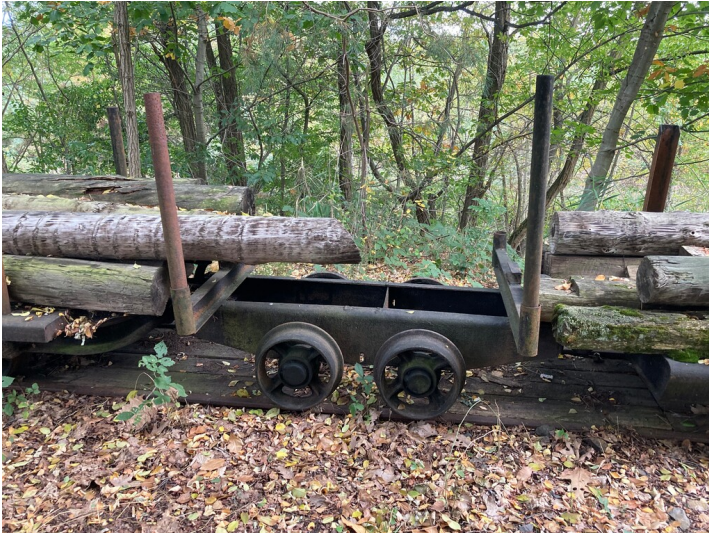
Rungenwagen auf Basis eines Kippförderwagens in geschweißter Ganzstahlbauweise Fotograf/Urheber: Tom Pfefferkorn
