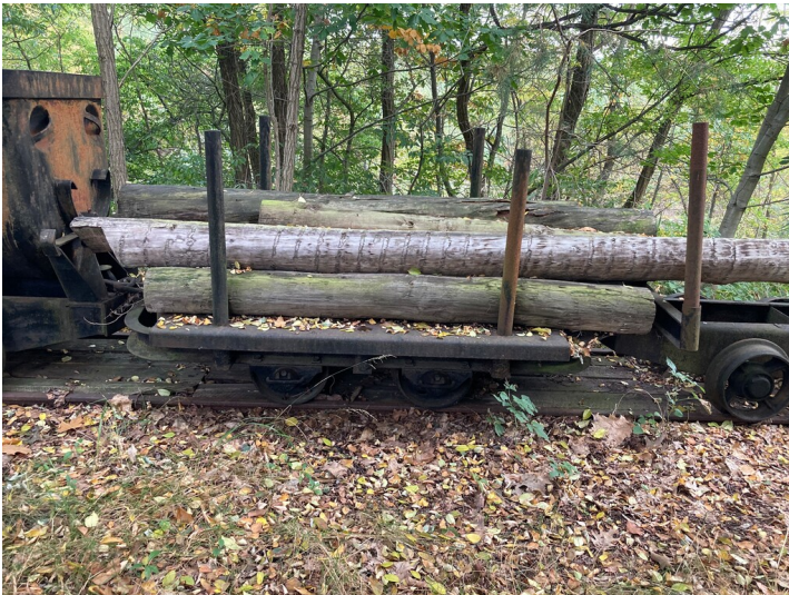
Materialtransportwagen/ Plattformwagen als Schweißkonstruktion mit Puffern aus Stahlguss Fotograf/Urheber: Tom Pfefferkorn
