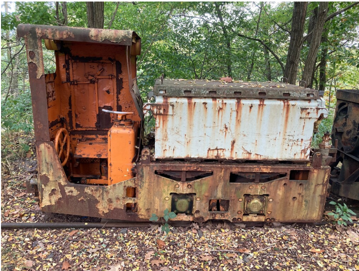
leichte Akku-Grubenlokomotive EL9 für den Untertageeinsatz, hier zur Veranschaulichung der Streckenentwässerung im Tagebau bis in die 1970er Jahre Fotograf/Urheber: Tom Pfefferkorn
