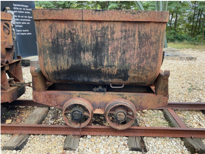
Kippförderwagen 3, 4 und 5 am Schachtgerüst Fotograf/Urheber: Tom Pfefferkorn
