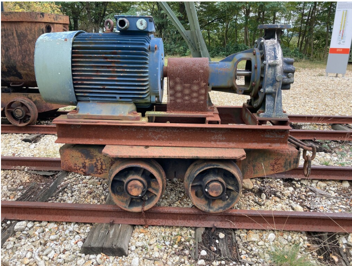
Plattformwagen mit Motorpumpe auf Basis eines Kippförderwagens Fotograf/Urheber: Tom Pfefferkorn
