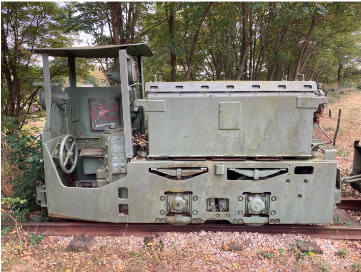
leichte Akku-Grubenlokomotive EL9 am Schachtgerüst Fotograf/Urheber: Tom Pfefferkorn
