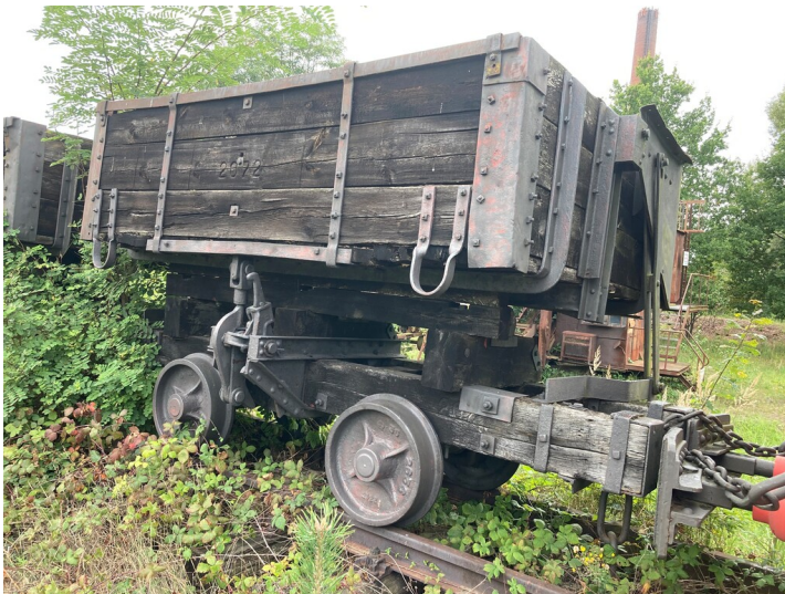
Fünf Abraum-Holzkippwagen (Nr. 2072, 3354, 3533, 3363, 2408), wohl die letzten erhaltenen ihrer Art in Deutschland Fotograf/Urheber: Tom Pfefferkorn
